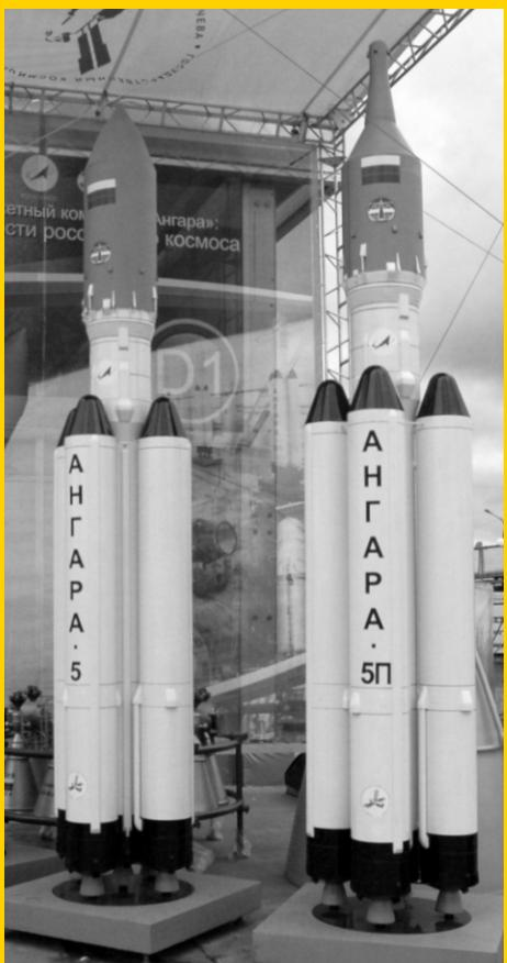
ТЕХНОЛОГИЧЕСКИЙ МАКЕТ РАКЕТЫ – это модель ракеты в натуральном или уменьшенном масштабе. Макеты позволяют быстро вносить изменения в конструкцию ракет, тестировать их транспортировку и другие технологические процессы.
